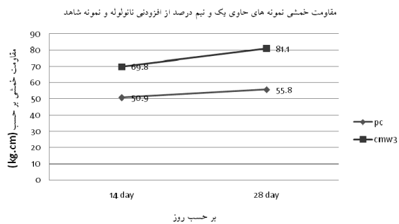
شکل (۷). مقایسه مقاومت خمشی نمونه های حاوی یک و نیم درصد از افزودنی نانولوله و نمونه شاهد
