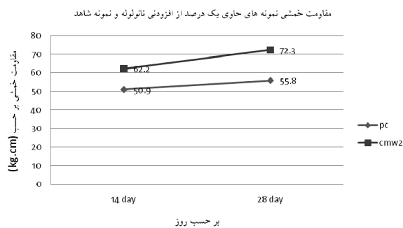
شکل (۶). مقایسه مقاومت خمشی نمونه های حاوی یک درصد از افزودنی نانولوله و نمونه شاهد
