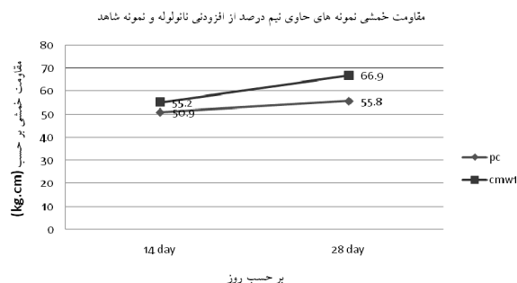
شکل (۵). مقایسه مقاومت خمشی نمونه های حاوی نیم درصد از افزودنی نانولوله و نمونه شاهد
